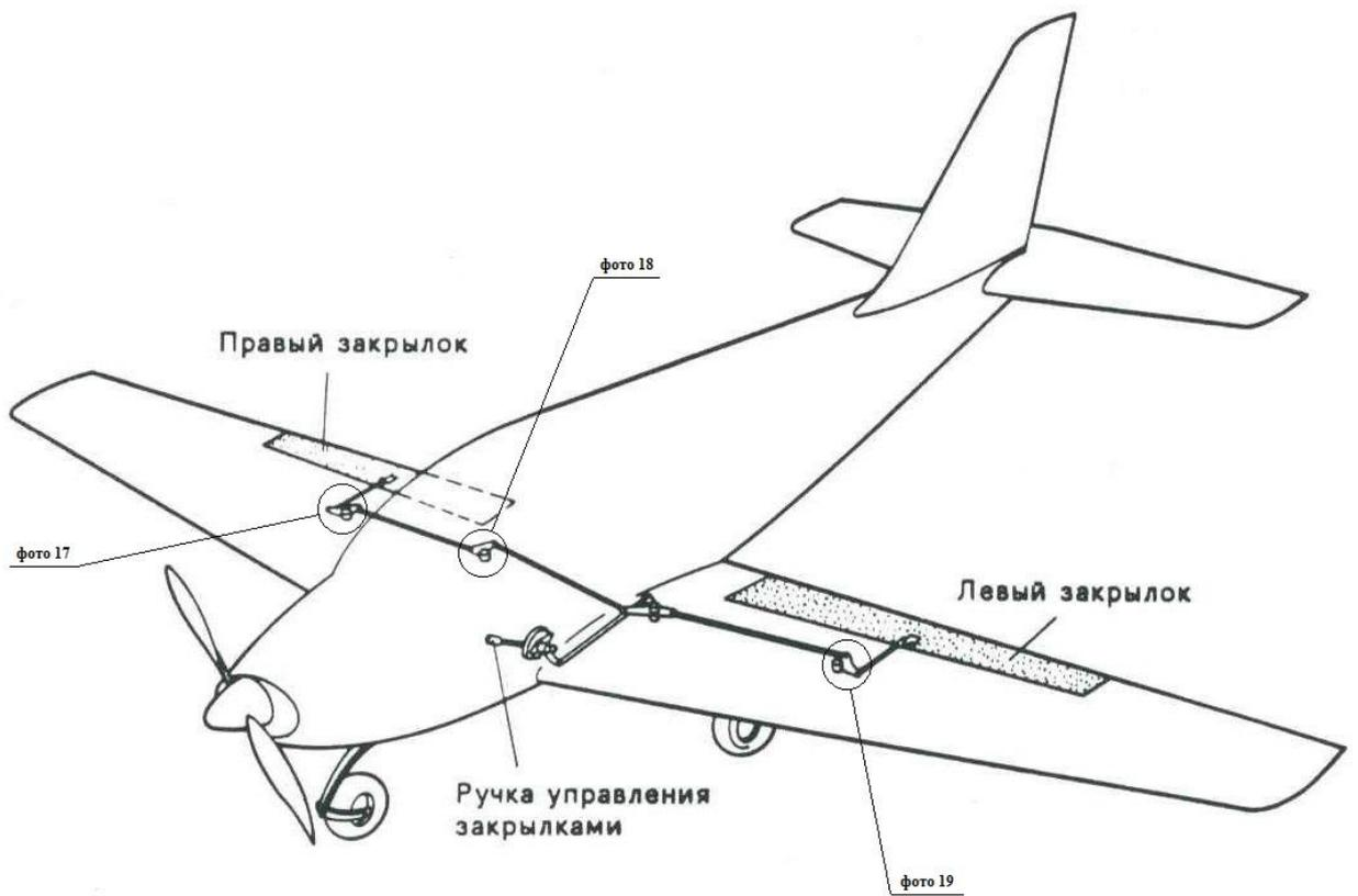
**Рис.5. Система управления закрылками**
