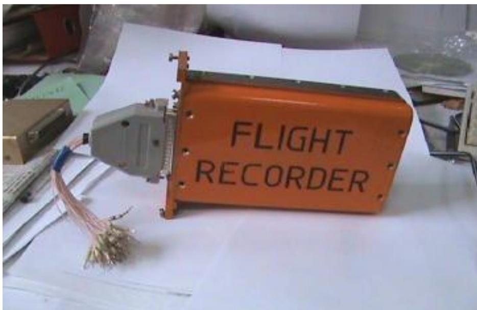
**Фото 5.** Технологический ЗТН-1-Н с подключенным жгутом Э-80-75
