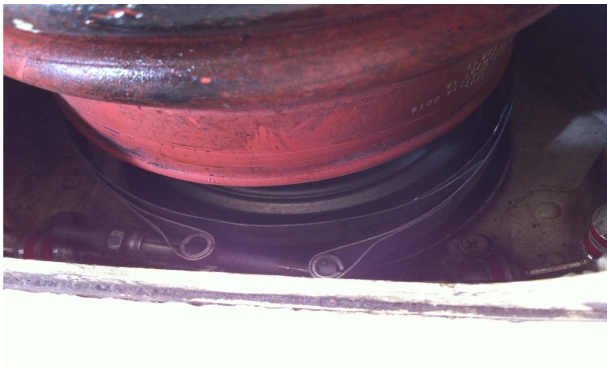
Фото 2. Гермо-узел (англ. APU Boot Pressure Seal) со сползшим с посадочного места хомутом (p/n BACC10BN500L5ME)
