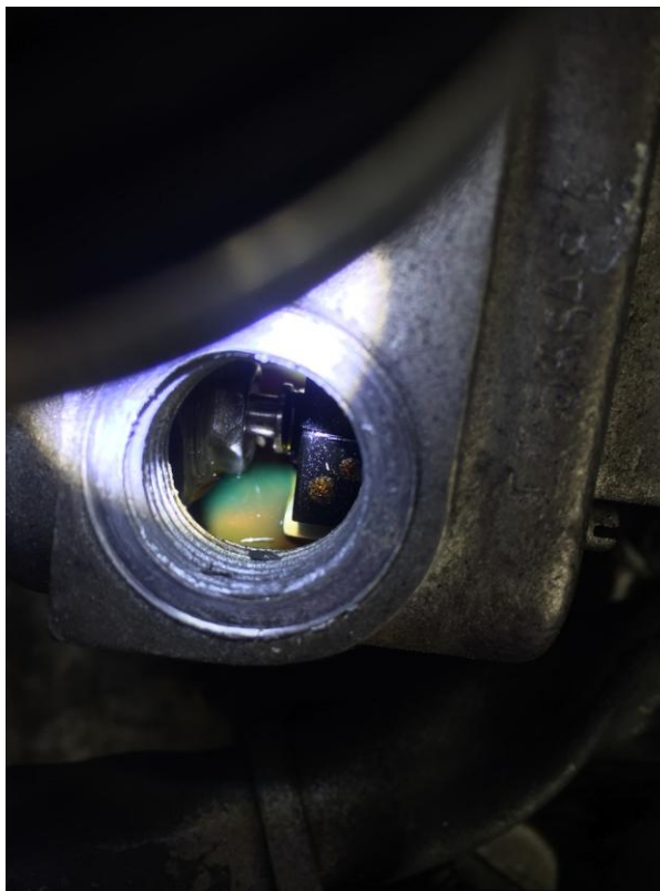
Фото 3. Полость концевых выключателей датчиков автоматического флюгирования ДАФ СУ № 2
