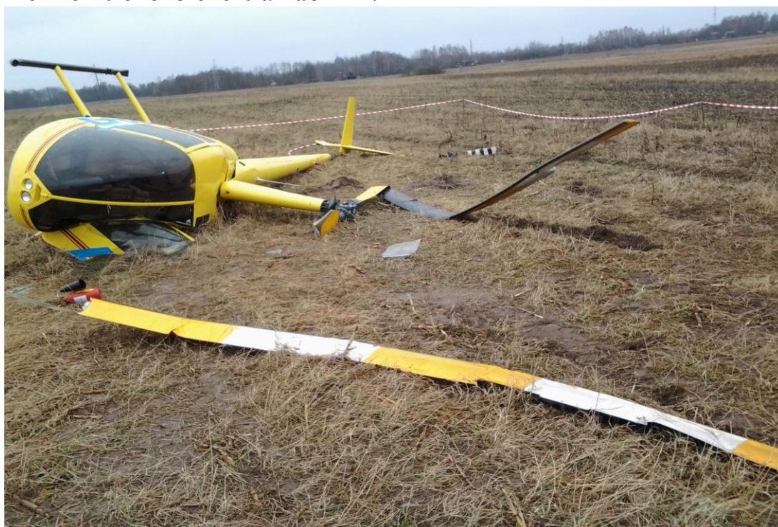
Фото 6. Повреждения конструкции ВС при столкновении с землей
