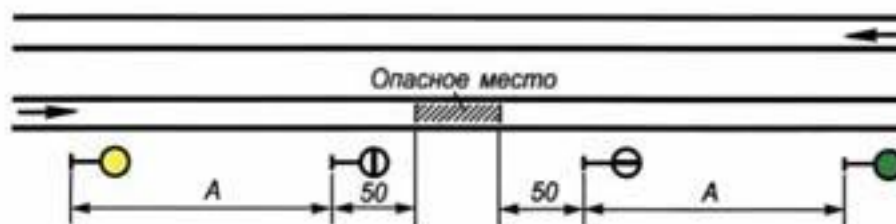
Рисунок 71. Схема установки постоянных дисков уменьшения скорости и сигнальных знаков «Начало опасного места» и «Конец опасного места» владельца инфраструктуры на одном из железнодорожных путей двухпутного участка
