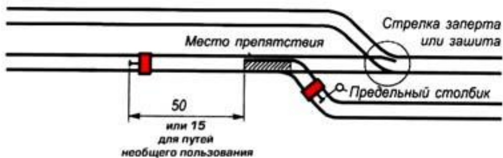
Рисунок 102. Ограждение переносными красными сигналами места препятствия или производства работ на стрелочном переводе при наличии изолирующей стрелки
