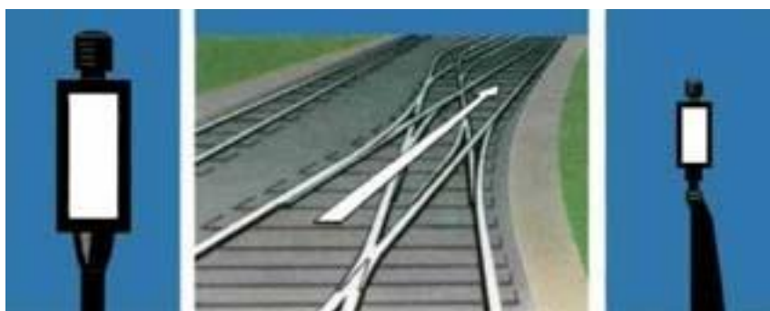
Рисунок 127. Обычные стрелочные указатели перекрестной стрелки, указывающие, что стрелки установлены по прямому железнодорожному пути
