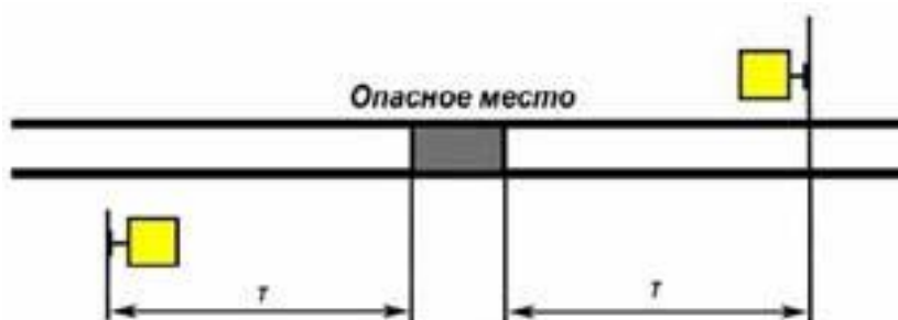
Рисунок 88. Схема установки сигнала уменьшения скорости на однопутном перегоне железнодорожных путей необщего пользования
