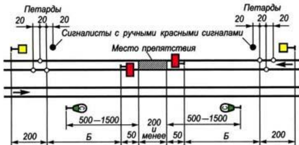
Рисунок 80. Схема ограждения препятствий и мест производства работ на железнодорожных путях общего пользования на одном из железнодорожных путей двухпутного участка
