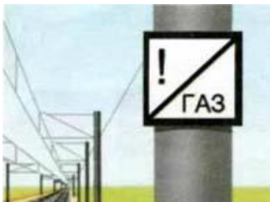
Рисунок 141. Постоянный сигнальный знак «Газ»
