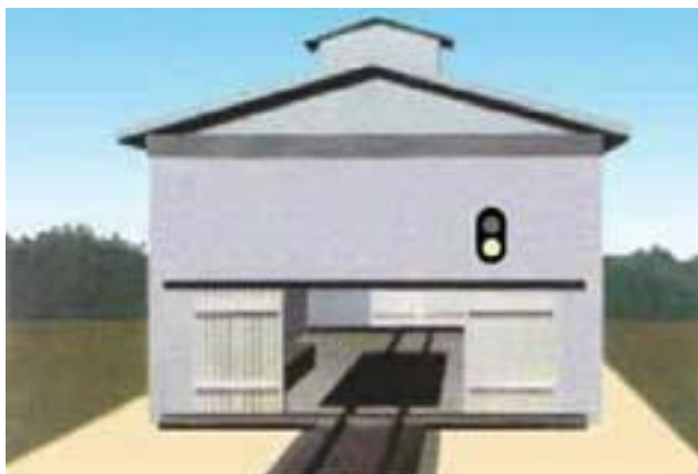
Рисунок 62. Въездной (выездной) светофор, применяемый на железнодорожных путях необщего пользования, сигнализирующий одним желтым огнем
