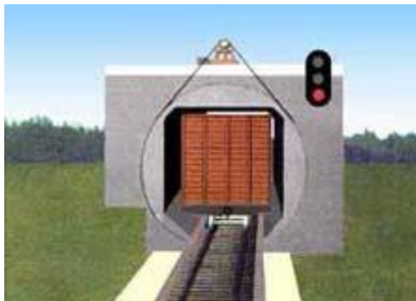
Рисунок 65. Технологический светофор, применяемый на железнодорожных путях необщего пользования, сигнализирующий красным огнем
