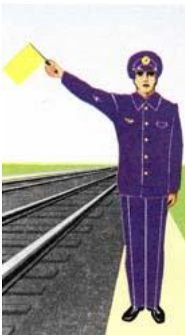
Рисунок 114. Подача сигнала уменьшения скорости в пределах железнодорожной станции
