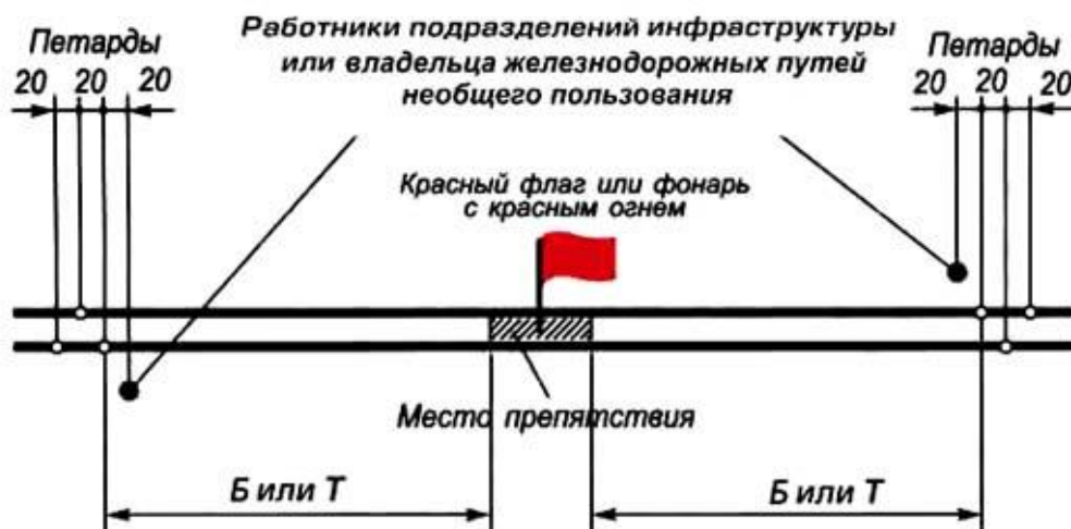
Рисунок 91. Порядок установки сигнала остановки при внезапном возникновении препятствия на перегоне и отсутствии необходимых переносных сигналов
