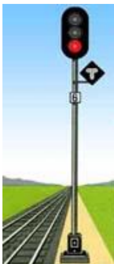
Рисунок 45. Проходной светофор, сигнализирующий одним красным огнем, с условно-разрешающим сигналом
