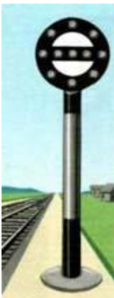
Рисунок 156. Постоянный сигнальный знак «Начало опасного места»
