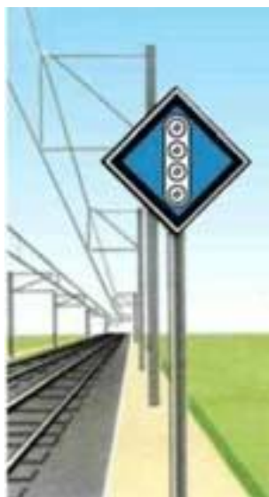
Рисунок 171. Временный сигнальный знак с отражателями «Поднять токоприемник»
