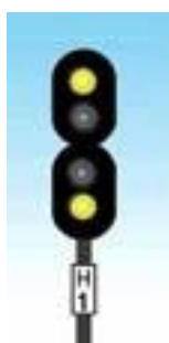
Рисунок 30. Выходной светофор, сигнализирующий двумя желтыми огнями
