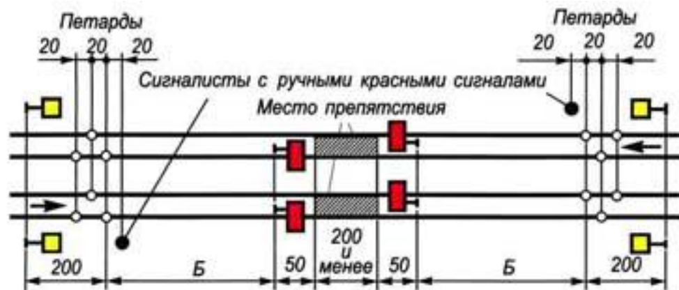
Рисунок 81. Схема ограждения препятствий и мест производства работ на железнодорожных путях общего пользования на обоих железнодорожных путях двухпутного участка
