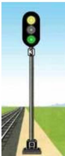
Рисунок 40. Светофор, сигнализирующий одним желтым и одним зеленым огнем
