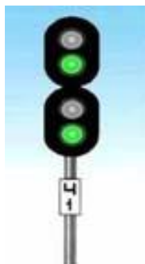
Рисунок 33. Выходной светофор, сигнализирующий двумя зелеными огнями
