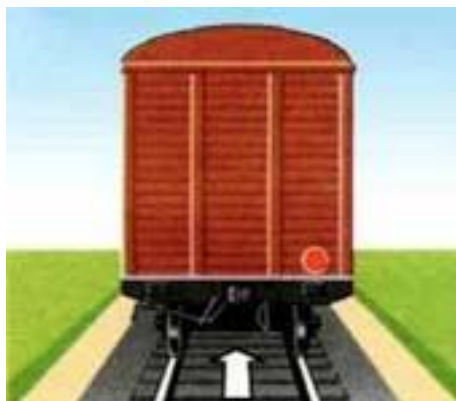
Рисунок 192. Обозначение хвостового вагона грузового и грузопассажирского поезда
