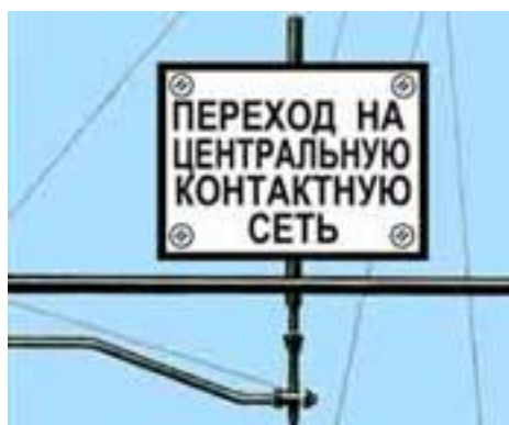
Рисунок 167. Предупредительный сигнальный знак «Переход на центральную контактную сеть»
