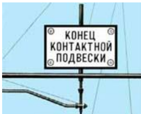
Рисунок 165. Сигнальный знак «Конец контактной подвески»
