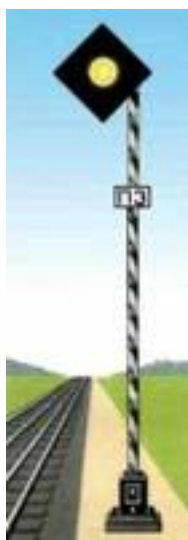
Рисунок 49. Предупредительный светофор перед заградительным светофором, сигнализирующий одним желтым огнем
