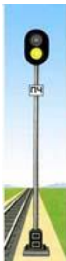
Рисунок 52. Предупредительный светофор перед входным, проходным и светофором прикрытия, сигнализирующий одним желтым огнем
