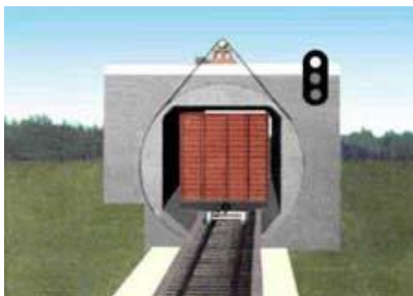
Рисунок 66. Технологический светофор, применяемый на железнодорожных путях необщего пользования, сигнализирующий одним лунно-белым огнем
