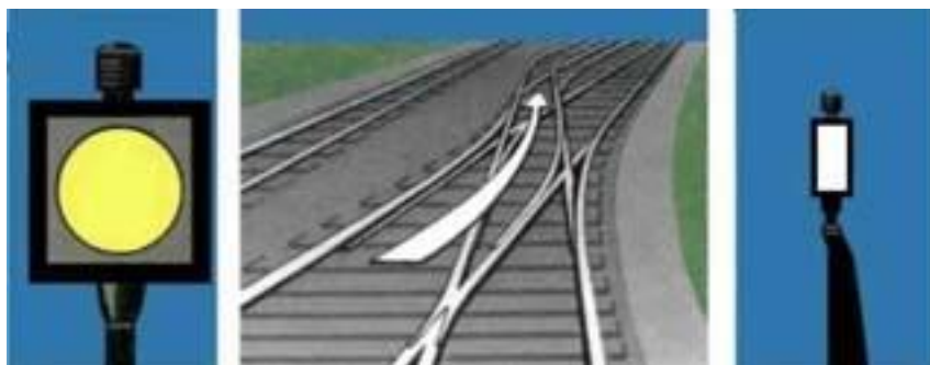
Рисунок 129. Обычные стрелочные указатели перекрестной стрелки, указывающие, что стрелки установлены с прямого на боковой железнодорожный путь
