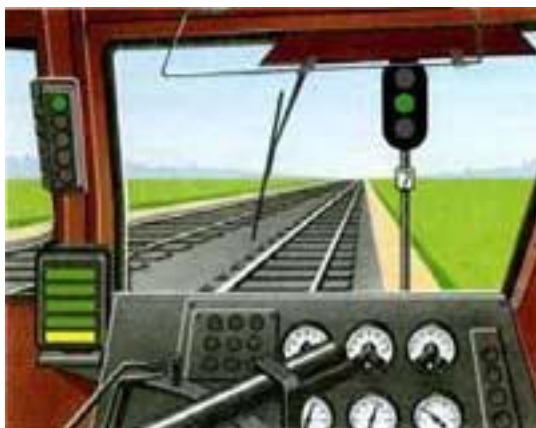
Рисунок 61. Устройство многозначной автоматической локомотивной сигнализации в кабине локомотива
