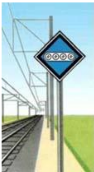
Рисунок 170. Временный сигнальный знак с отражателями «Опустить токоприемник»
