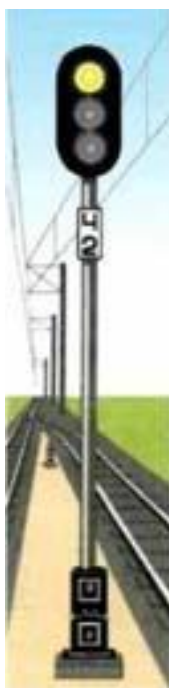
Рисунок 19. Выходной светофор, сигнализирующий одним желтым огнем
