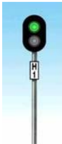
Рисунок 28. Выходной светофор, сигнализирующий одним зеленым огнем
