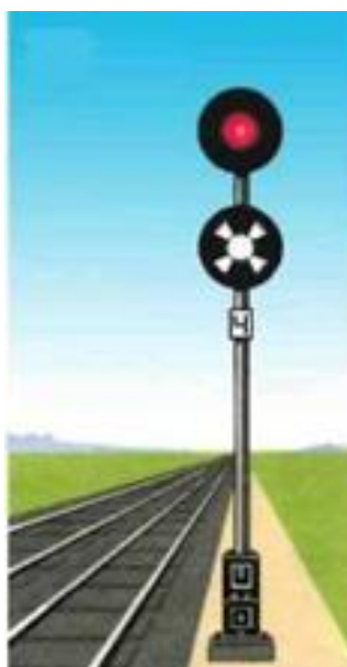
Рисунок 17. Пригласительный сигнал, разрешающий поезду проследовать светофор с красным (или погасшим) огнем, на железнодорожных путях необщего пользования
