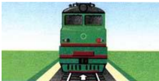
Рисунок 194. Обозначение локомотива, находящегося в хвосте грузового поезда, а также следующего без вагонов
