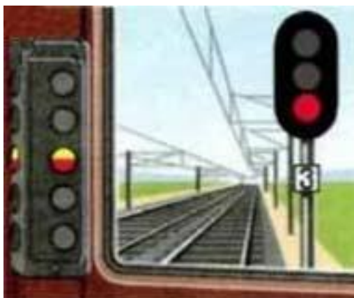
Рисунок 58. Локомотивный светофор, сигнализирующий желтым огнем с красным
