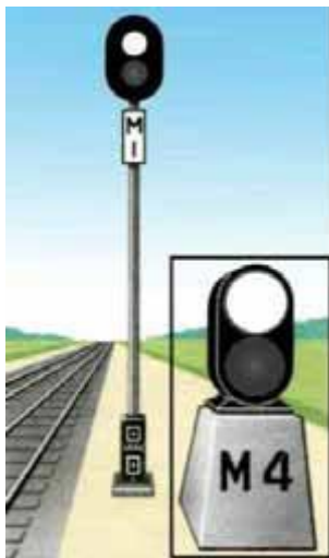
Рисунок 181. Маневровые светофоры, сигнализирующие одним лунно-белым огнем
