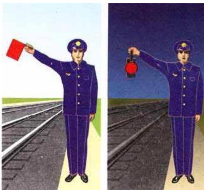
Рисунок 112. Подача ручным сигналом требования об остановке
