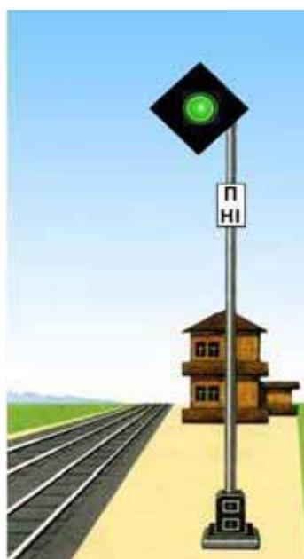
Рисунок 53. Повторительный светофор, сигнализирующий одним зеленым огнем
