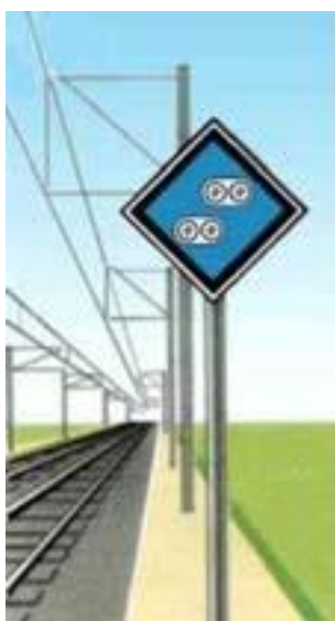
Рисунок 169. Временный сигнальный знак с отражателями «Подготовиться к опусканию токоприемника»
