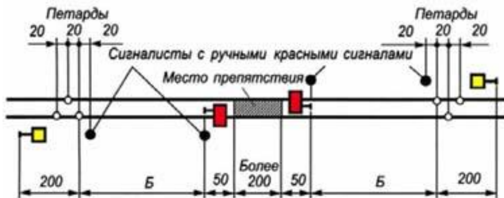
Рисунок 85. Схема ограждения места препятствия и места производства работ при производстве работ развернутым фронтом
