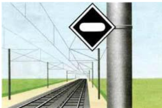
Рисунок 140. Сигнальный световой указатель «Опустить токоприемник»
