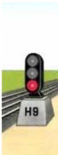
Рисунок 22. Выходной карликовый светофор, сигнализирующий одним красным огнем
