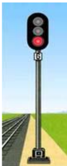
Рисунок 39. Проходной светофор, сигнализирующий одним красным огнем
