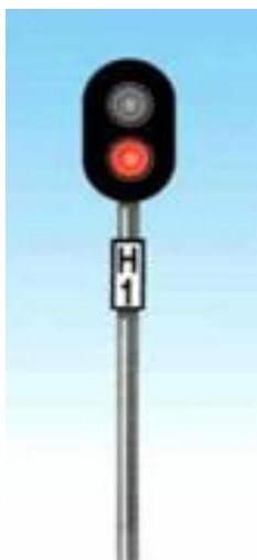
Рисунок 29. Выходной светофор, сигнализирующий одним красным огнем
