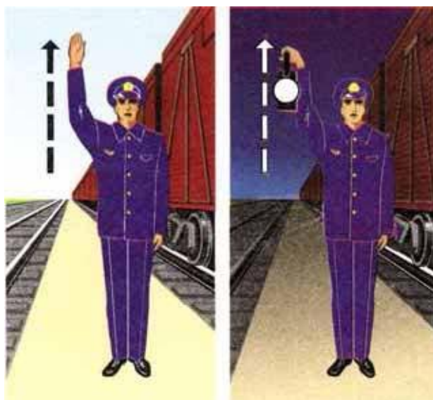
Рисунок 116. Требование машинисту произвести пробное торможение
