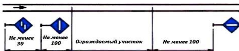
Рисунок 172. Схема установки временных сигнальных знаков на железнодорожных путях общего пользования
