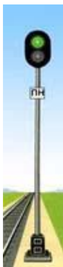
Рисунок 51. Предупредительный светофор перед входным, проходным и светофором прикрытия, сигнализирующий одним зеленым огнем
