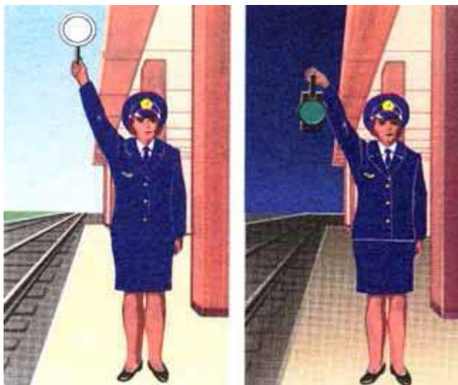
Рисунок 118. Подача ДСП станции сигнала при отправлении или проходе поезда по железнодорожной станции без остановки
