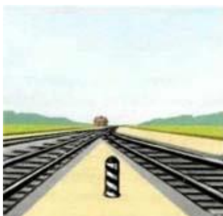
Рисунок 154. Предельный столбик у главных и прямо-отправочных железнодорожных путей
