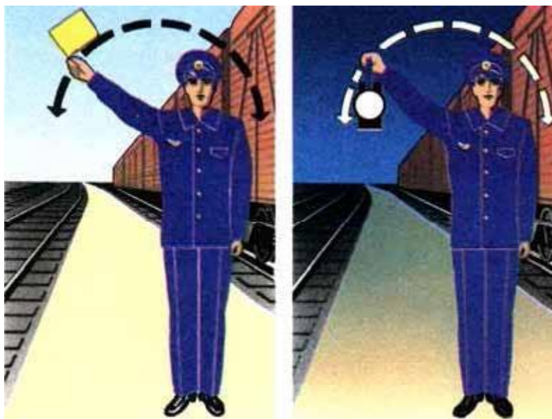
Рисунок 184. Подача сигнала, разрешающего локомотиву следовать управлением вперед
