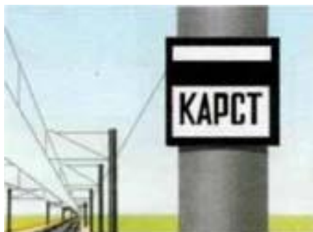
Рисунок 143. Постоянный сигнальный знак «Начало карстоопасного участка»
