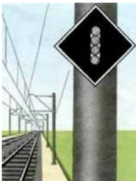
Рисунок 148. Постоянный сигнальный знак с отражателями «Поднять токоприемник»
