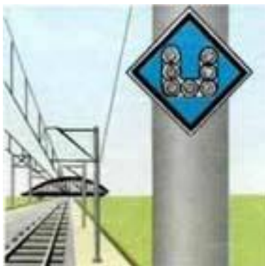
Рисунок 161. Предупредительный сигнальный знак «Включить ток на электровозе»
