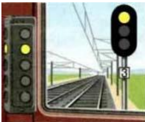
Рисунок 57. Локомотивный светофор, сигнализирующий желтым огнем
