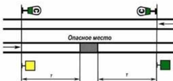
Рисунок 89. Схема установки сигнала уменьшения скорости на одном из железнодорожных путей двухпутного перегона железнодорожных путей необщего пользования
