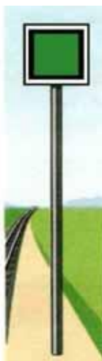
Рисунок 78. Обратная сторона переносного сигнала – квадратного щита (зеленого цвета)
