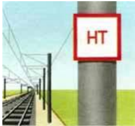
Рисунок 145. Постоянный сигнальный знак «Начало торможения»
