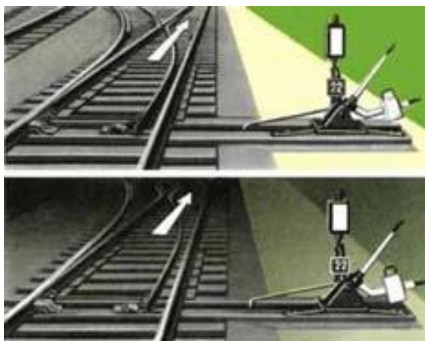
Рисунок 125. Освещаемый стрелочный указатель одиночной стрелки, указывающий, что стрелка установлена по прямому железнодорожному пути
