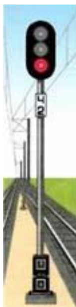
Рисунок 23. Выходной мачтовый светофор, сигнализирующий одним красным огнем
