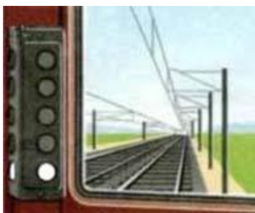
Рисунок 60. Локомотивный светофор, сигнализирующий белым огнем
