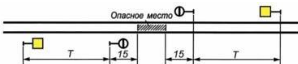
Рисунок 72. Схема установки постоянных дисков уменьшения скорости и сигнальных знаков «Начало опасного места» и «Конец опасного места» владельца инфраструктуры на обоих железнодорожных путях двухпутного участка
