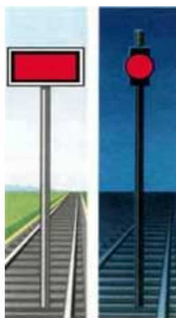
Рисунок 76. Переносные сигналы – прямоугольный щит красного цвета и красный огонь фонаря на шесте
