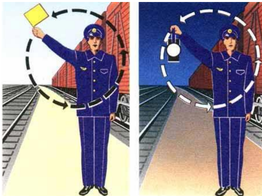
Рисунок 187. Подача сигнала, требующего остановки
