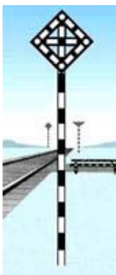
Рисунок 175. Временный сигнальный знак «Поднять нож, закрыть крылья»
