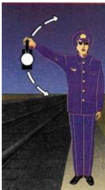
Рисунок 115. Подача сигнала уменьшения скорости ручным фонарем с прозрачно-белым огнем
