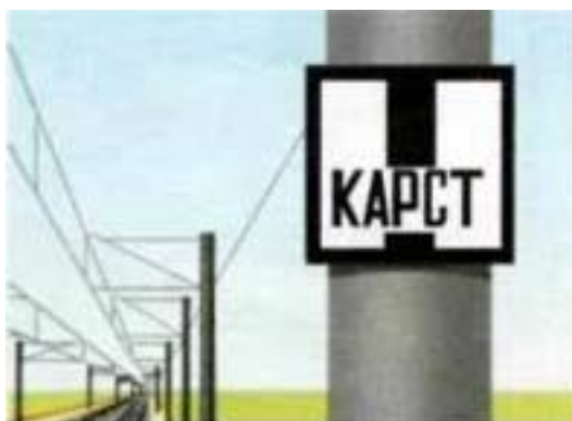
Рисунок 144. Постоянный сигнальный знак «Конец карстоопасного участка»
