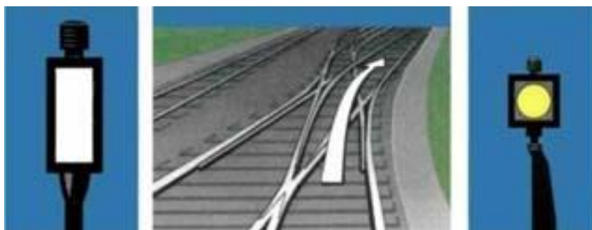
Рисунок 130. Обычные стрелочные указатели перекрестной стрелки, указывающие, что стрелки установлены с бокового на прямой железнодорожный путь
