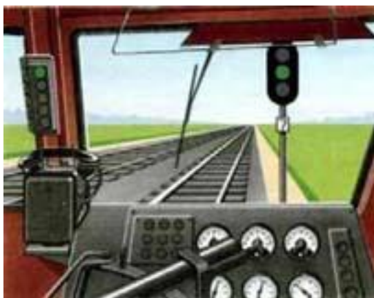
Рисунок 56. Локомотивный светофор, сигнализирующий зеленым огнем
