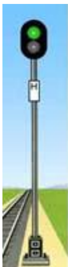
Рисунок 43. Проходной светофор, сигнализирующий одним зеленым огнем один красный огонь – стой! Запрещается проезжать сигнал (рисунок 44).
