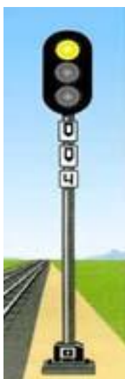
Рисунок 38. Проходной светофор, сигнализирующий одним желтым огнем, со световым указателем белого цвета в виде двух вертикальных стрел
