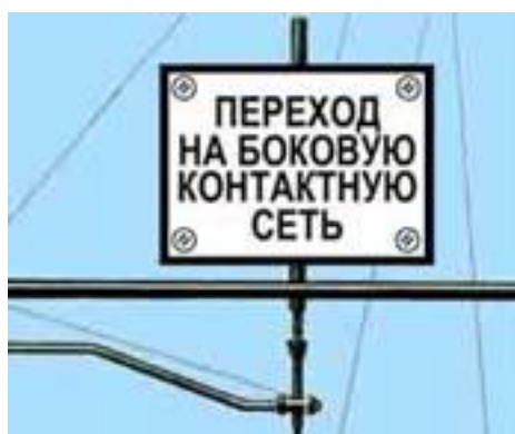
Рисунок 166. Предупредительный сигнальный знак «Переход на боковую контактную сеть»
