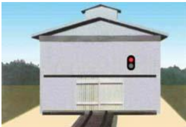
Рисунок 63. Въездной (выездной) светофор, применяемый на железнодорожных путях необщего пользования, сигнализирующий красным огнем
