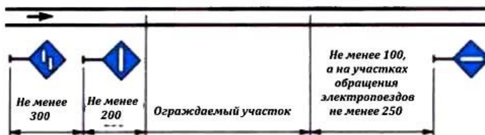
Рисунок 172. Схема установки временных сигнальных знаков на железнодорожных путях общего пользования
