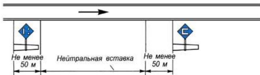
Рисунок 164. Схема установки предупредительных сигнальных знаков на железнодорожных путях необщего пользования
