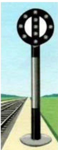
Рисунок 157. Постоянный сигнальный знак «Конец опасного места»
