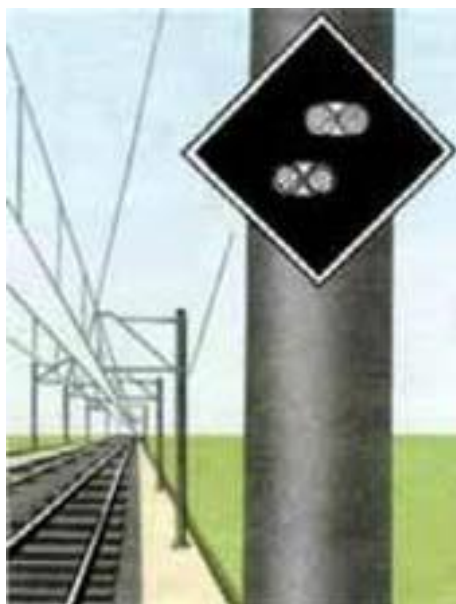
Рисунок 147. Постоянный сигнальный знак с отражателями «Внимание! Токораздел»
