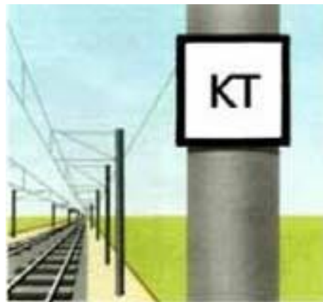
Рисунок 146. Постоянный сигнальный знак «Конец торможения»
