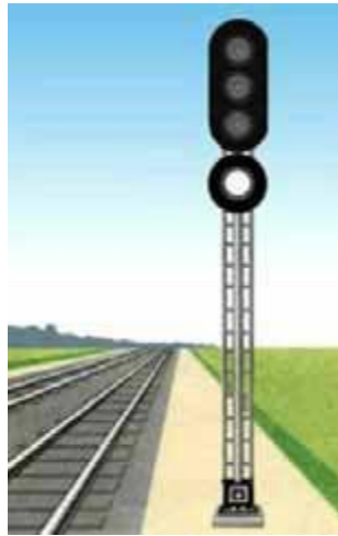
Рисунок 7. Сигнал на железнодорожных путях необщего пользования, допускаемый к применению в дополнение к сигналам входных светофоров
