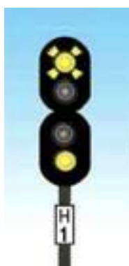
Рисунок 30а. Выходной светофор, сигнализирующий двумя желтыми огнями, из них верхним мигающим
