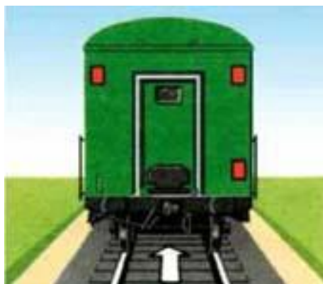
Рисунок 193. Обозначение хвостового вагона пассажирского и почтово-багажного поезда
