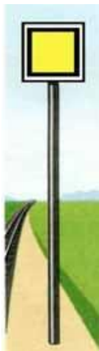
Рисунок 77. Переносной сигнал – квадратный щит желтого цвета
