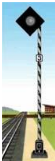
Рисунок 50. Заградительный светофор с нормально не горящими сигнальными огнями
