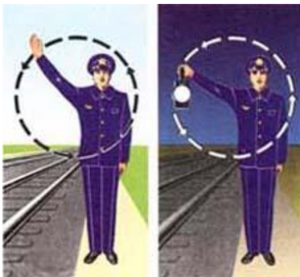
Рисунок 113. Подача ручным сигналом требования об остановке
