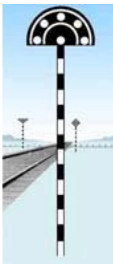
Рисунок 177. Временный сигнальный знак «Подготовиться к поднятию ножа и закрытию крыльев»
