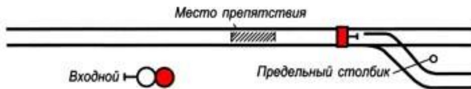
Рисунок 104. Ограждение места препятствия или производства работ, находящегося между входным сигналом и входной стрелкой
