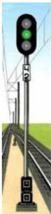
Рисунок 18. Выходной светофор, сигнализирующий одним зеленым огнем
