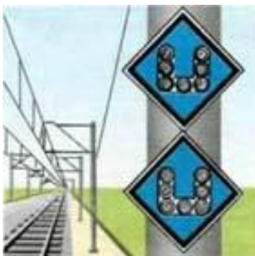
Рисунок 162. Предупредительный сигнальный знак «Включить ток на электропоезде»
