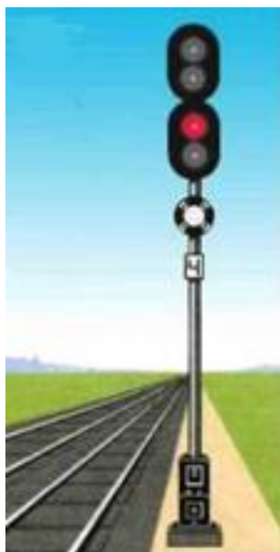
Рисунок 16. Пригласительный сигнал, разрешающий поезду проследовать светофор с красным (или погасшим) огнем, на железнодорожных путях общего пользования
