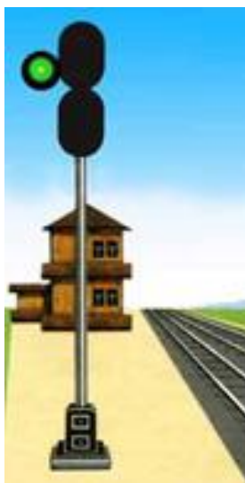
Рисунок 36. Повторительная головка, установленная на выходной (маршрутный) светофор, и сигнализирующая зеленым огнем при открытом выходном (маршрутном) светофоре
