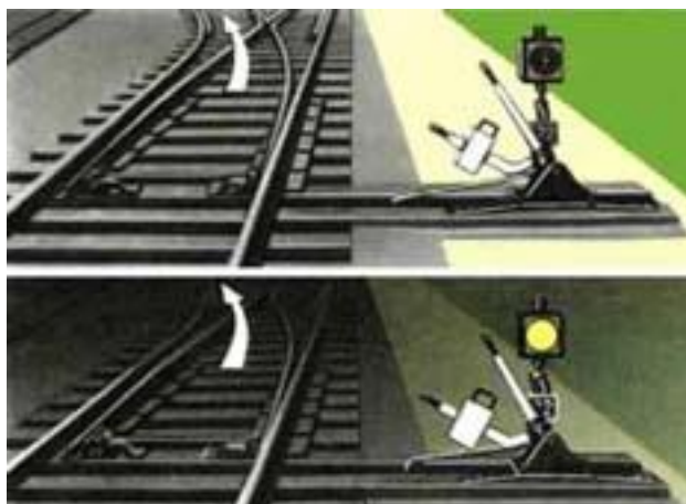
Рисунок 126. Освещаемый стрелочный указатель одиночной стрелки, указывающий, что стрелка установлена на боковой железнодорожный путь
